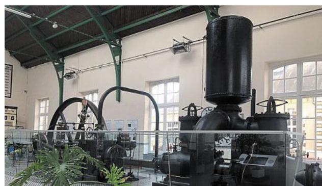
Incontournable de la visite, la machine à vapeur qui servait autrefois à refouler l'eau vers les réservoirs de distribution, ainsi que le grand tableau de commande. PHOTO : JM
